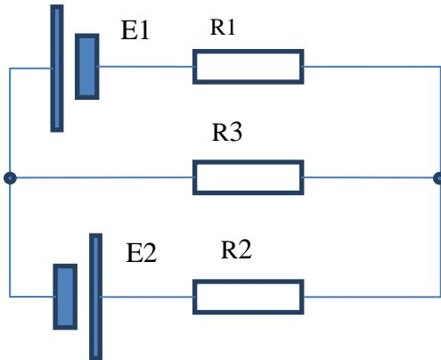
Найти в Mathcad, используя законы Кирхгофа, все токи в электрической схеме сначала в общем виде, а потом численно, если  $R_1 = 0.4 \text{ кОм}$ ,  $R_2 = 40 \text{ Ом}$ ,  $R_3 = 1 \text{ кОм}$ ,  $E_1 = 12 \text{ В}$ ,  $E_2 = 13 \text{ В}$ . В каждом случае представить результат в виде вектора решений  $\begin{pmatrix} J_1 \\ J_2 \\ J_3 \end{pmatrix}$ .
