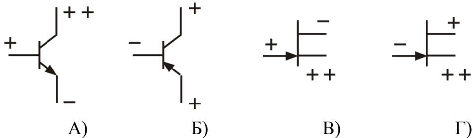
30 Укажите потенциалы на электродах биполярного транзистора, обеспечивающие его работы в режиме насыщения.
