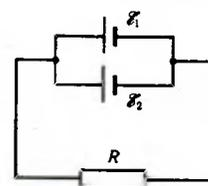
сопротивлениями  $r_1 = 1 \text{ Ом}$  и  $r_2 = 1,5 \text{ Ом}$ , замкнуты на внешнее сопротивление  $R = 1,4 \text{ Ом}$ . Найти ток в каждом из элементов и во всей цепи.
