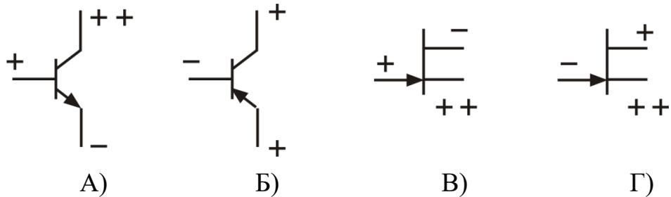
32 Укажите потенциалы на электродах полевого транзистора с управляющим *p-n* переходом, обеспечивающие его работу в режиме отсечки.
