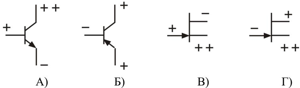
31 Укажите потенциалы на электродах полевого транзистора с управляющим *p-n* переходом, обеспечивающие его работы в режиме усиления.
