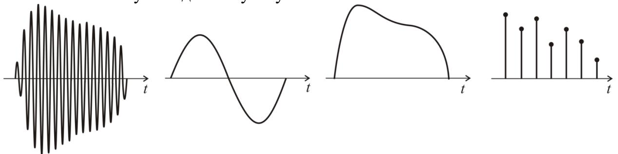
15 Укажите, какая из приведенных ниже графических зависимостей соответствует гармоническому сигналу?
