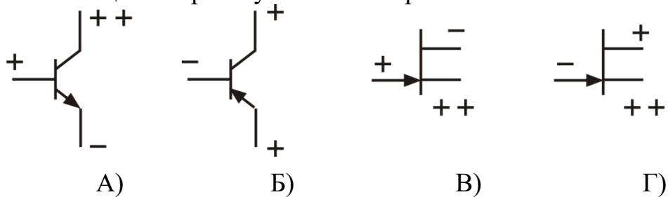
30 Укажите потенциалы на электродах биполярного транзистора, обеспечивающие его работы в режиме насыщения.
