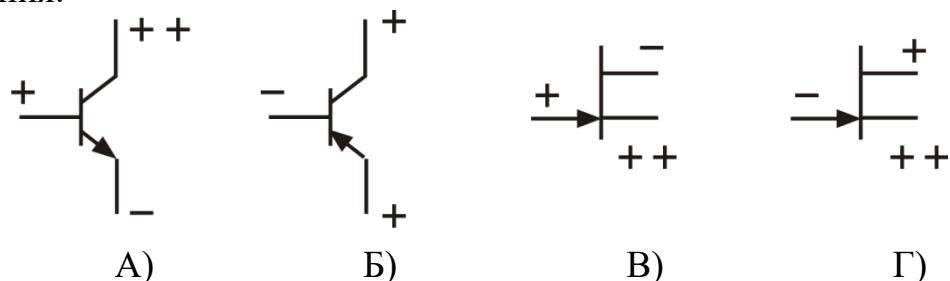
32 Укажите потенциалы на электродах полевого транзистора с управляющим  $p-n$  переходом, обеспечивающие его работу в режиме отсечки.
