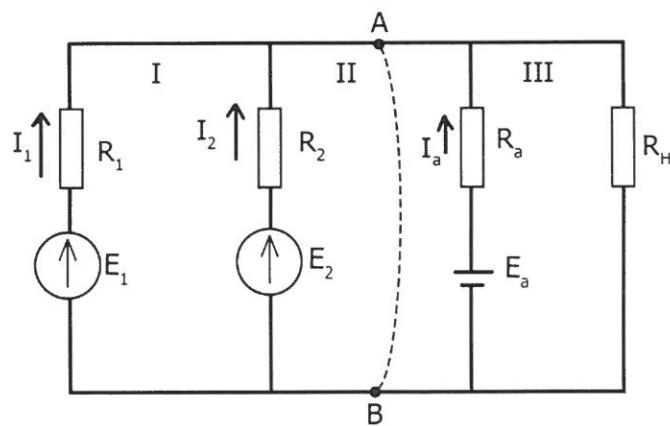
Задача 2. Согласно схеме и при условии заданных параметров: а) вычислите ток в цепи I; б) определите сдвиг фаз на выводах цепи; в) рассчи-
