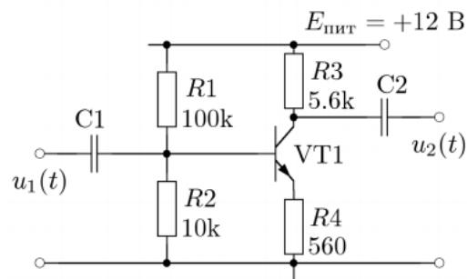
3. Используя принцип виртуального замыкания, найти формулу, выражающую зависимость выходного напряжения от входного:
