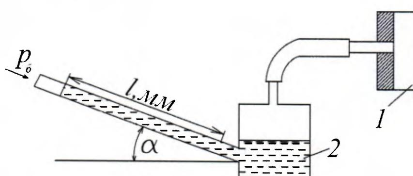
Определить абсолютное давление в воздухопроводе 1, если длина  $l$  столба жидкости в трубке микроманометра 2, наклонённой под углом  $\alpha=30^\circ$ , равна  $(180+N_0)$ мм.
