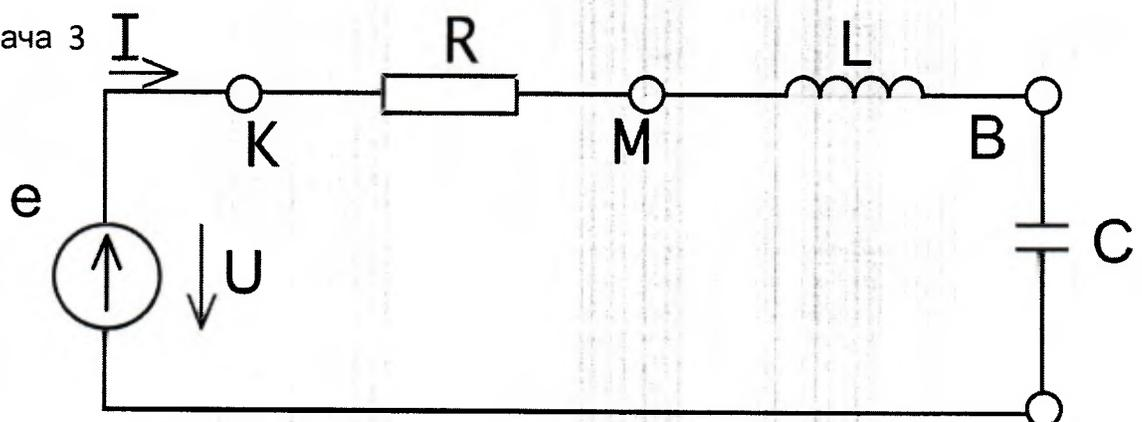
**Условие:** Электрическая цепь с последовательно соединённым резистором  $R$ , катушкой индуктивности  $L$  и конденсатором  $C$  питается от генератора синусоидального тока с частотой  $f$  и напряжением  $U$
