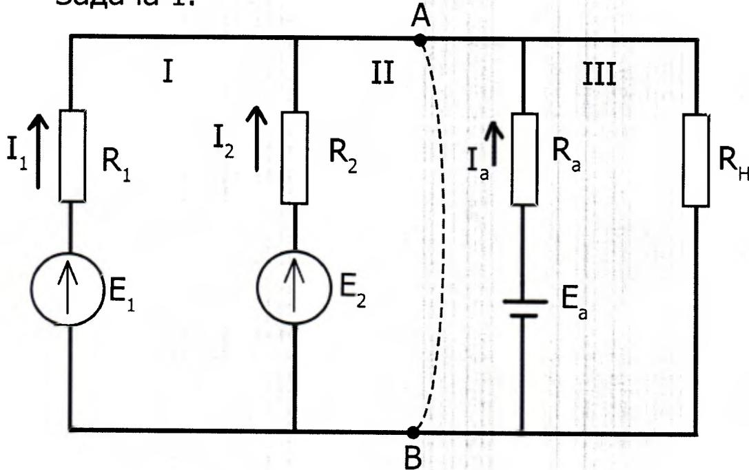
**Условие:** два источника ЭДС (генераторы) с ЭДС  $E_1$ ,  $E_2$  и с сопротивлениями в соответствующих ветвях электрической цепи  $R_1$  и  $R_2$  питают нагрузку  $R_n$  и аккумуляторную батарею с ЭДС  $E_a$  и сопротивлением  $R_a$  (рис. 2.7).
