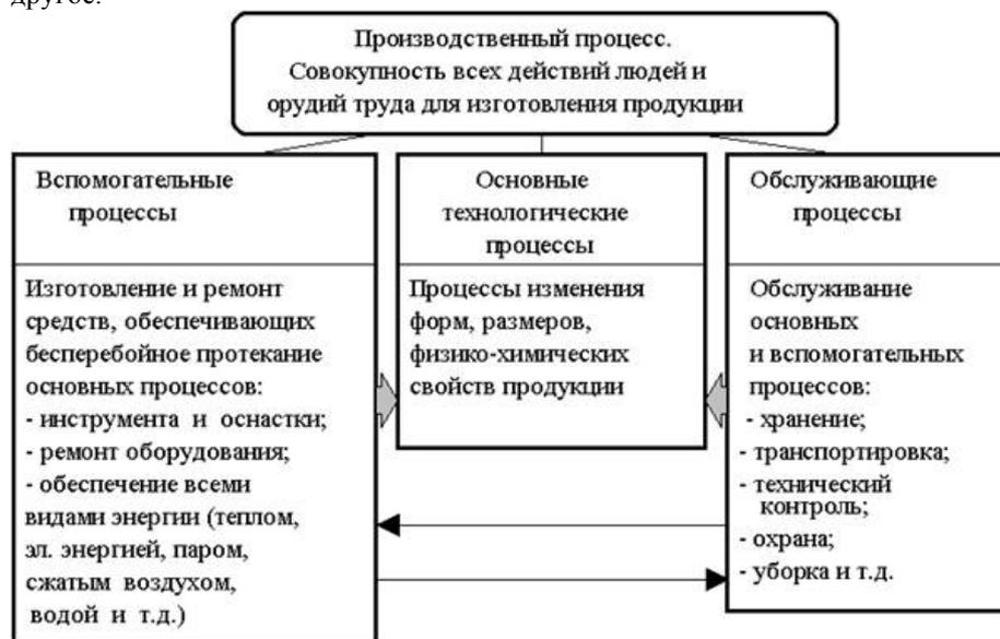
Рис. 3 Структура производственных процессов
