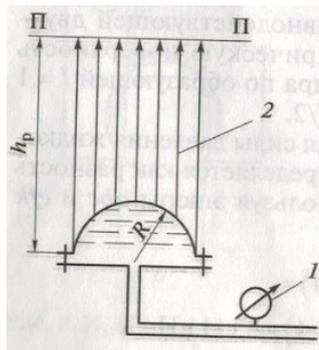
Расчетная схема: 1-манометр; 2-тело давления; П-П-пьезометрическая плоскость
