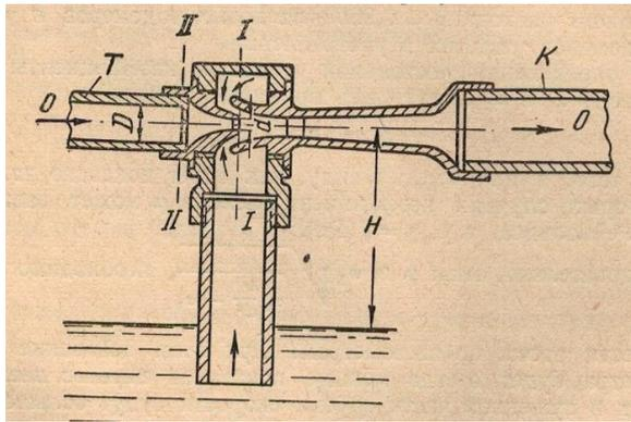
Что нужно сделать, чтобы увеличить высоту подъема жидкости из бака, используя этот же эжектор? Какое влияние на величину вакуума оказывает минимальное сечение эжектора, и почему в эксплуатации необходимо обеспечивать его чистоту?
