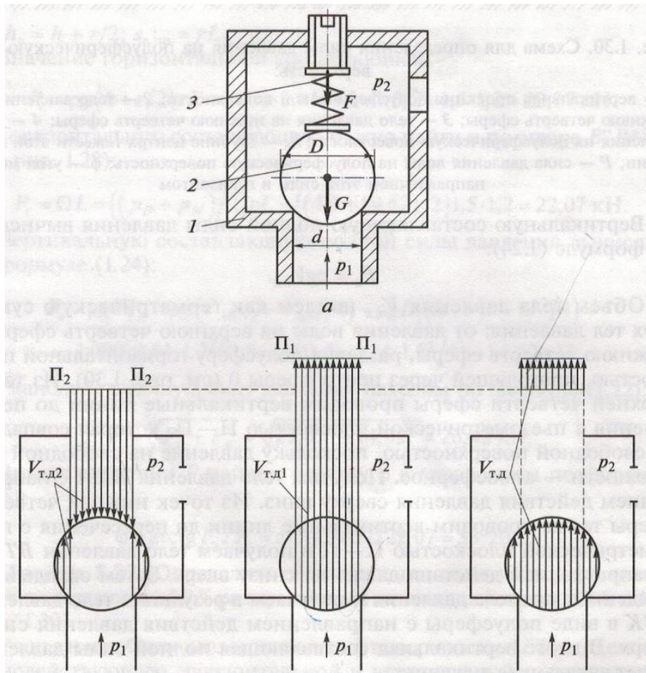
Расчетная схема с телами давления от действия  $P_2$ ,  $P_1$  и суммарного действия
