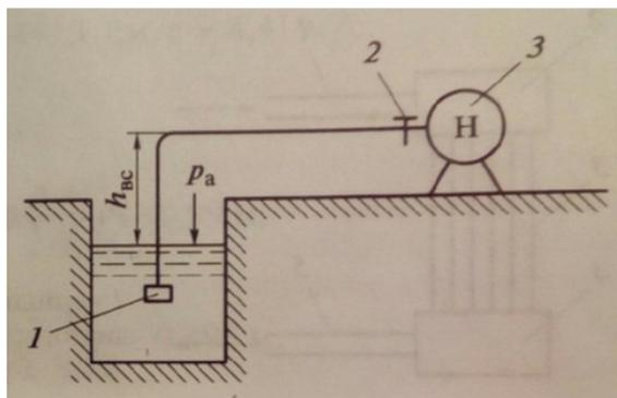
Сколько механической энергии будет у  $1 \text{ м}^3$  топлива перед насосом? Какой вакуум должен создаваться насосом во всасывающем патрубке?
