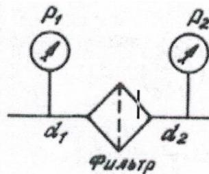
Как будут изменяться показания манометра  $P_2$  при загрязнении фильтра, если диаметры трубопроводов будут одинаковые? Обоснуйте свой ответ, используя уравнение Бернулли. Как это отразится на свойствах жидкости и дальнейшей эксплуатации данной жидкостной системы?
