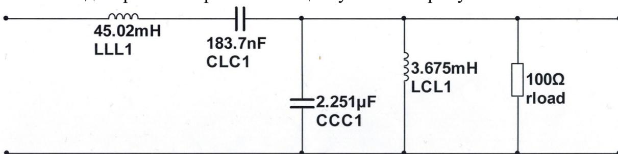
2. Для электрической цепи, заданной принципиальной схемой, путем имитационного моделирования произвести оценку полосы пропускания.
