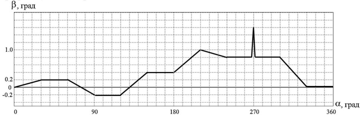
24. Применение методов расчета зон действия радиотехнических средств в рамках организации радиотехнического обеспечения полетов воздушных судов. Рассчитать зону действия радиотехнического средства исходя из заданного графика углов закрытия.
