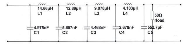
3. Для электрической цепи, заданной принципиальной схемой, путем имитационного моделирования произвести оценку полосы пропускания.
