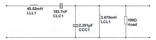
2. Для электрической цепи, заданной принципиальной схемой, путем имитационного моделирования произвести оценку полосы пропускания.
