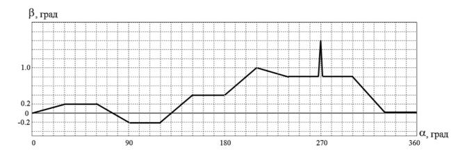
24. Применение методов расчета зон действия радиотехнических средств в рамках организации радиотехнического обеспечения полетов воздушных судов. Рассчитать зону действия радиотехнического средства исходя из заданного графика углов закрытия.
