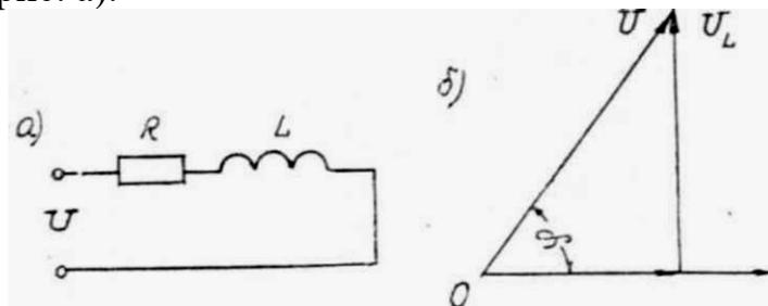
Определить ток, активную и реактивную составляющие напряжения, коэффициент мощности, активную, реактивную и полную мощности катушки. Построить векторную диаграмму.
