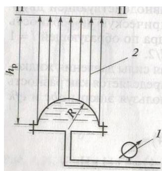
Расчетная схема: 1-манометр; 2-тело давления; П-П-пьезометрическая плоскость
