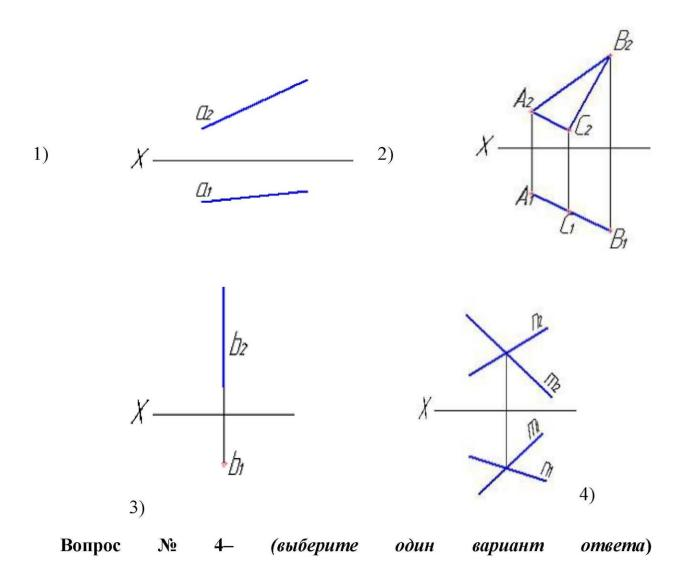
При преобразовании чертежа способом замены плоскостей проекций дополнительные плоскости проекций по отношению к имеющимся выбираются...
