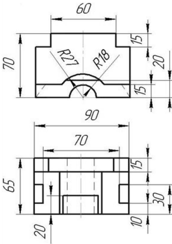
Задача №2 Построить линию пересечения плоскостей. Определить видимость плоскостей.
